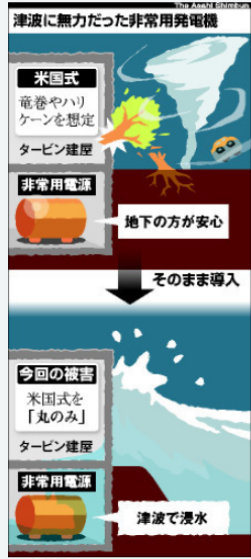
津波に無力だった非常用発電機
